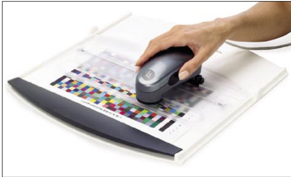
Figure 12. Le Eye-One Pro permet une mesure rapide des mires pour caractériser les imprimantes
